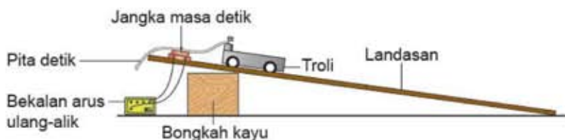
Rajah 11.10 Susunan radas
