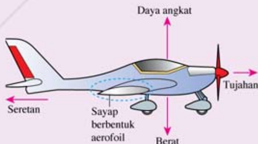
(d) Penghasilan daya angkat oleh aerofoil dan sudut serang bagi kapal terbang
