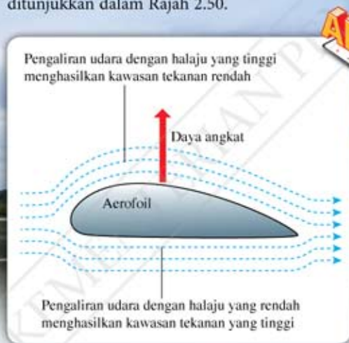
Rajah 2.50 Penghasilan daya angkat oleh aerofoil
