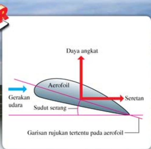
Rajah 2.51 Sudut serang pada aerofoil
