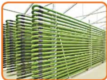
Gambar foto 3.11 Loji mikroalga yang digunakan dalam Teknologi Emisi Negatif
