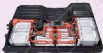
Gambar foto 3.5 Pek bateri dalam kenderaan elektrik
