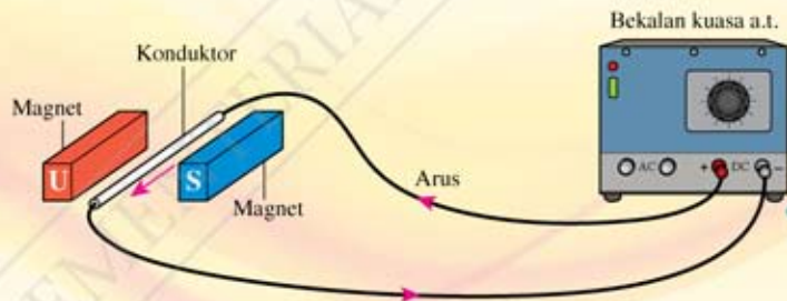
Rajah 4.2 Konduktor pembawa arus yang diletakkan di antara dua magnet
