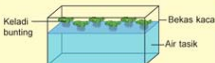
Rajah 4.14 Susunan radas kaedah fitoremediasi
