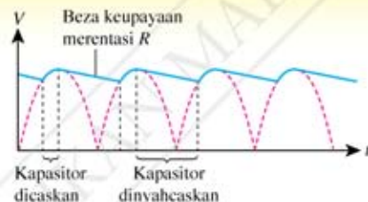
Rajah 5.12 Perataan output rectifikasi gelombang separuh dan gelombang penuh oleh kapasitor
