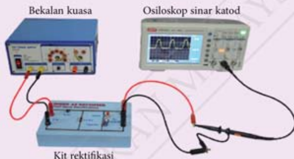
Gambar foto 5.3 Kit Rektifikasi gelombang separuh
