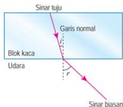
Rajah 6.4 Pembiasan cahaya dari blok kaca ke udara ( i < r )
