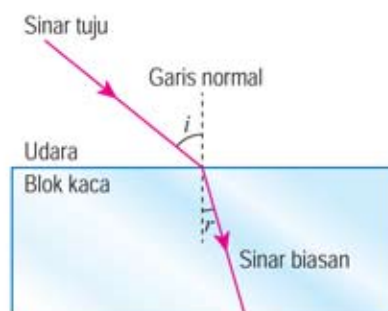
Rajah 6.3 Pembiasan cahaya dari udara ke blok kaca ( i > r )
