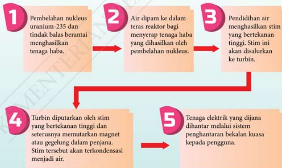
Rajah 6.12 Struktur reaktor nuklear dan proses penjanaan tenaga elektrik di stesen jana kuasa nuklear
