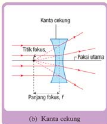
Rajah 7.3 Titik fokus dan panjang fokus bagi kanta cembung dan kanta cekung
