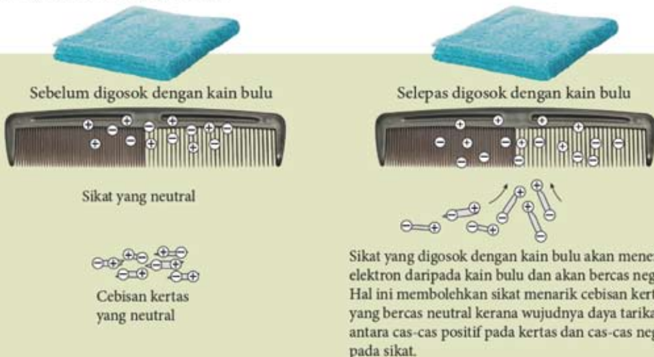
Rajah 7.4 Kesan penghasilan cas elektrostatik
