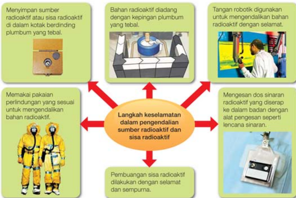
Rajah 8.14 Langkah keselamatan dalam pengendalian sumber radioaktif dan sisa radioaktif
