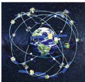
Rajah 9.8 Ilustrasi rangkaian satelit GPS (Image © NOAA)
